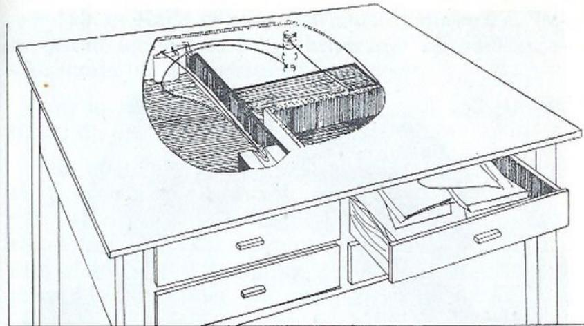
Sl. 67. Mina naoružana baterijskim upaljačem pripremljena za aktiviranje na potez
